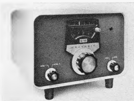
Bild 5. Zusatzoszillator SB 640, der die Betriebsmöglichkeiten des Transceivers SB 101 beträchtlich erweitert
